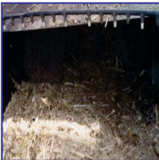
चित्र-5: कीटाणुनाशक तथा पर्यावरण अनुकूल रसायनों का छिड़काव करना कीटाणुनाशक तथा पर्यावरण अनुकूल रसायनों का छिड़काव फाइबराइज्ड गन्ने पर करने से लगभग 01 यूनिट चीनी परता बढ़ जाता है।
